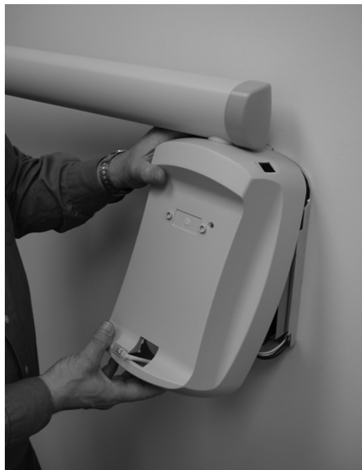
Figure 36 Positionnement du capot sur l'unité de commande
