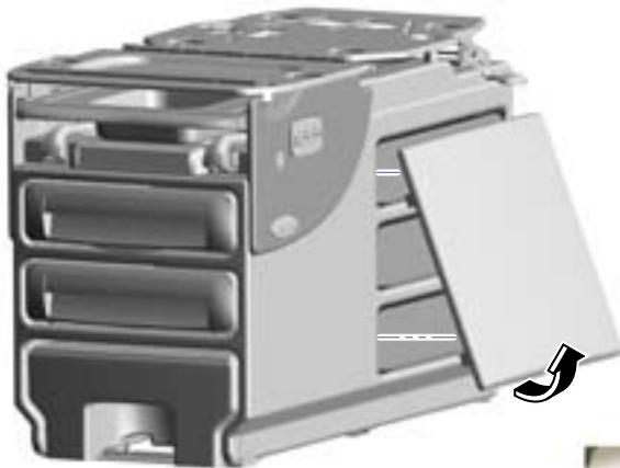
**Schritt 1:** Die Seitenabdeckung entfernen.
