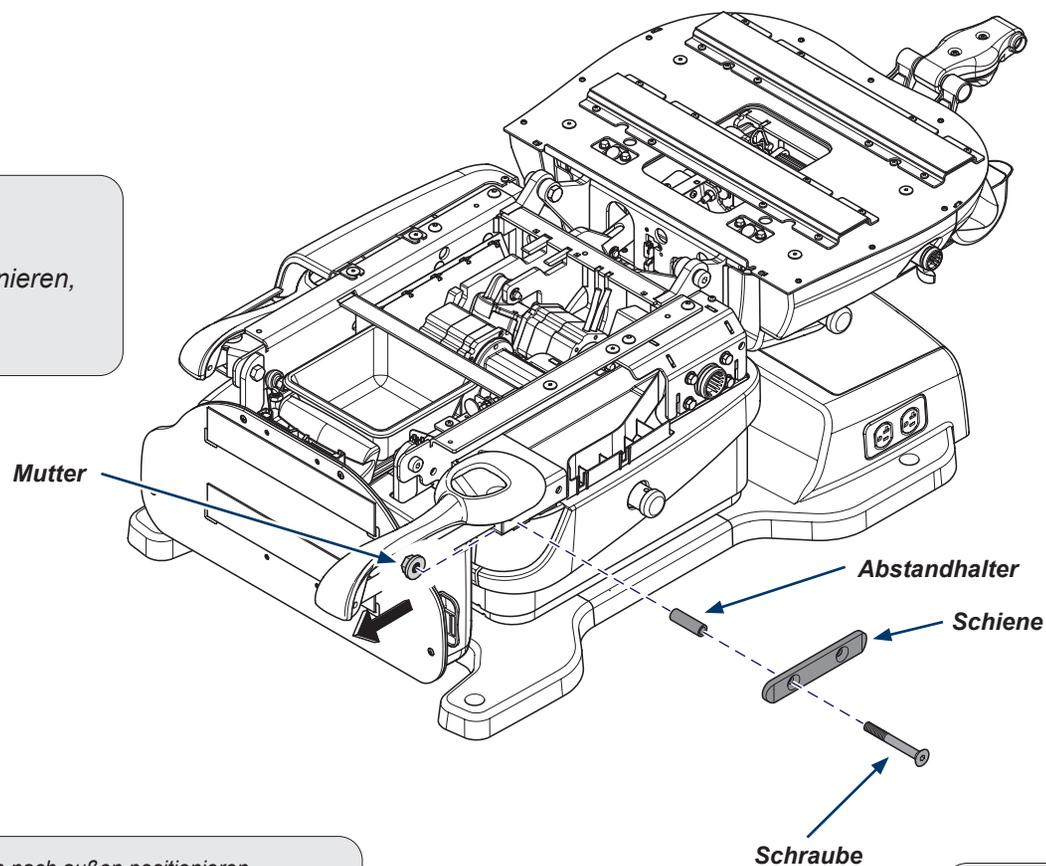
Hinweis: Schiene mit großem Loch nach außen positionieren, sodass die Schrauben bündig zur Schiene abschließen.
