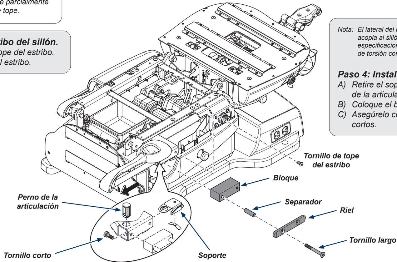
Nota: El lateral del bloque sin pintar se acopla al sillón. Consulte la hoja de especificaciones para obtener el par de torsión correcto.
