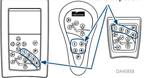
Utilisez les boutons et sur tout dispositif de commande pour placer la chaise dans la position souhaitée.
