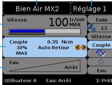
**Nom pré-réglage** - jusqu'à 10 pré-réglages par utilisateur
