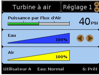
S'affiche lorsqu'une pièce à main Turbine à air est retirée de son support. Commandes actives : Norm pré-réglage et Réglage de l'eau.
