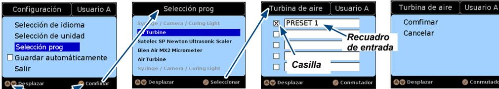
Activar Guardar automáticamente  = ACTIVADO (por defecto) Todos los ajustes de control modificados se guardan automáticamente en el Usuario/Programa indicado. DESACTIVAR ( = DESACTIVADO) Alterar los ajustes repetidamente sin guardarlos, o pulsar el indicado de Guardar para guardar en ese Usuario/Programa.
