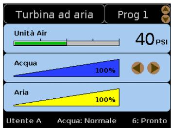
Compare quando viene sollevato un manipolo della turbina ad aria.
