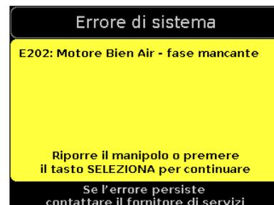
Compare quando viene rilevato un errore. Seguire le istruzioni su schermo. Se l'errore è specifico di un manipolo, il funzionamento degli altri manipoli non dovrebbe esserne interessato.
