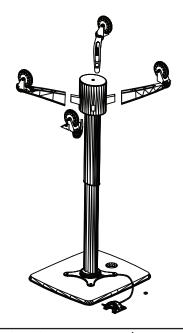
EXTREME CAUTION!! - BEFORE INSTALLING THE NEW CARTRIDGE, IT NEEDS TO BE EXPANDED TO THE FULL HEIGHT POSITION.
